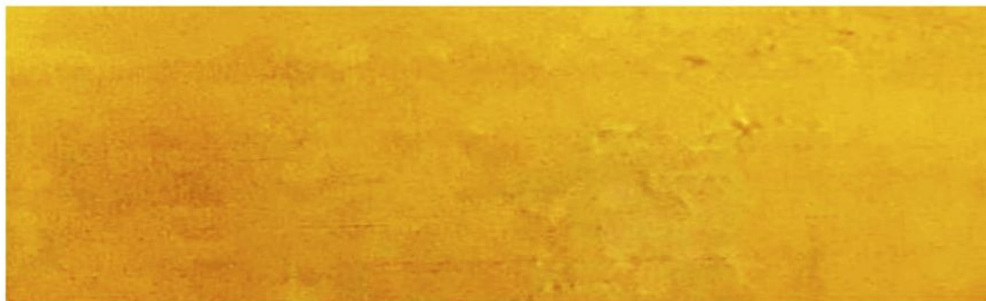
Рисунок Б.3 — Типичное изображение поверхности МБВ, соответствующее наилучшему распределению МД в битуме
