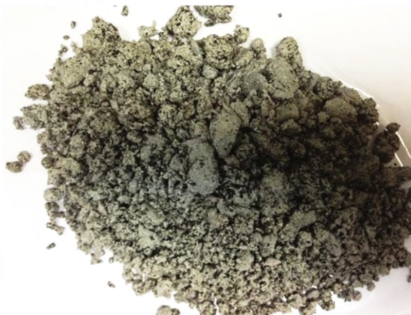
Рисунок А.1 — Смесь с битумной эмульсией, не пригодной для приготовления смесей по показателю обволакиваемости
