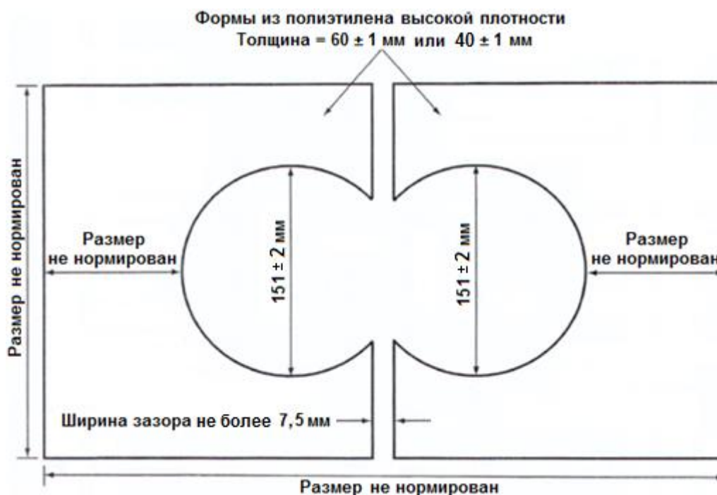
Рисунок 6. Форма для установки цилиндрических образцов.
