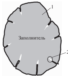
Рисунок 4 – Изображение эффективного объема заполнителя V_s
