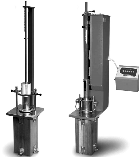
Рисунок 20 – Уплотнители Маршалла с ручным (а) и механическим (б) молотами
