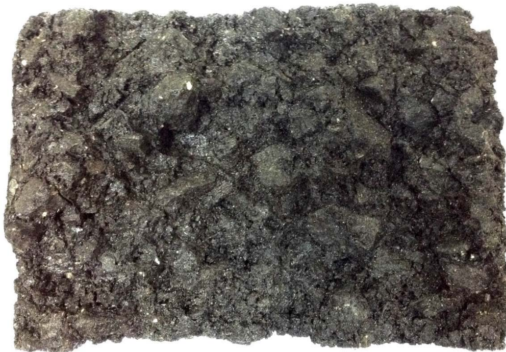
Рисунок А.8 – Поверхность разлома асфальтобетонного образца
