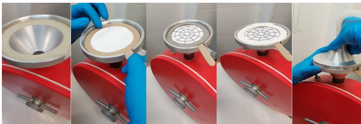
Рисунок 10. Схема сборки фильтродержателя (аллонжа) с фильтром АФА 40
