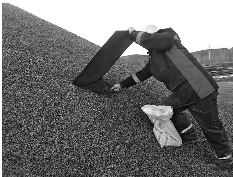
Рисунок 8 — Отбор точечных проб из штабеля с помощью пробоотборного листа
