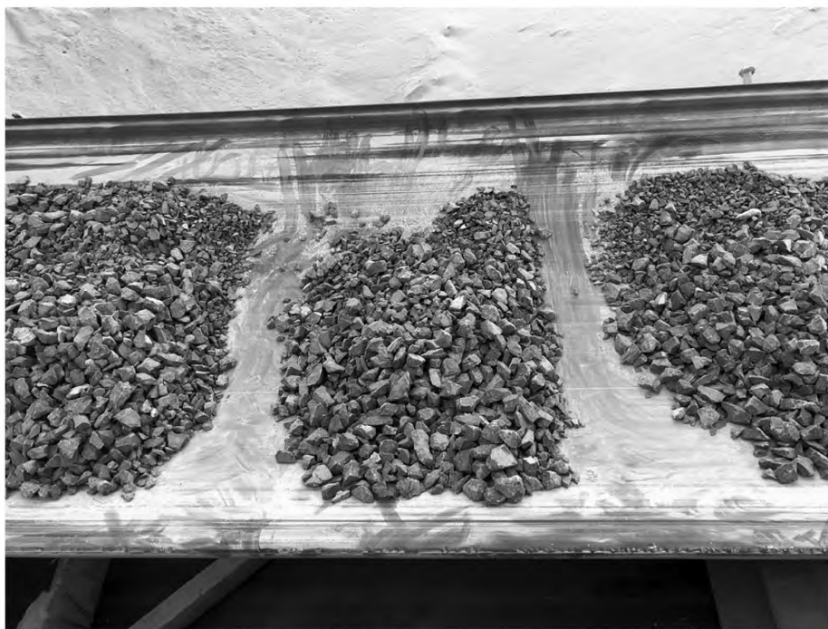
Рисунок 4 — Отбор точечной пробы без применения пробоотборной рамы
