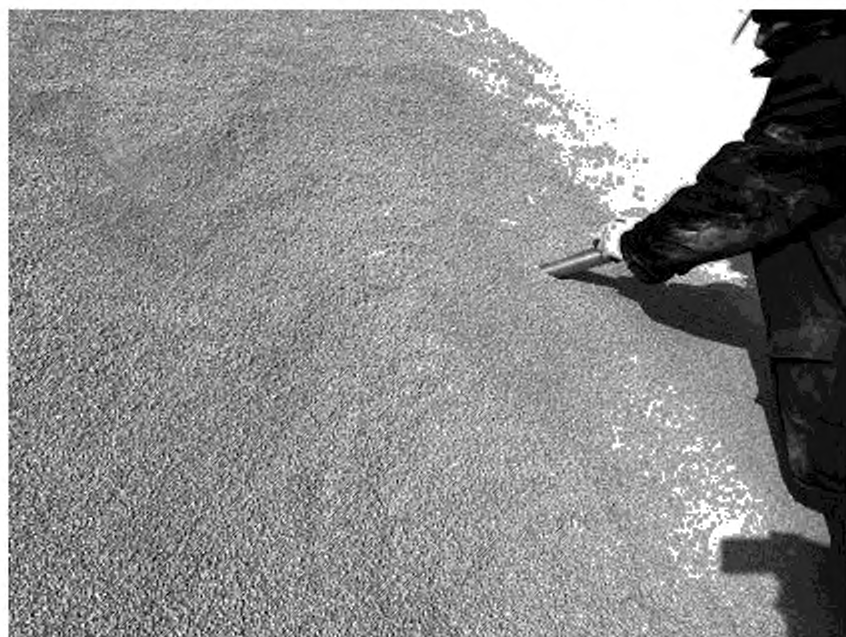
Рисунок 9 — Отбор точечных проб песка пробоотборной трубкой
