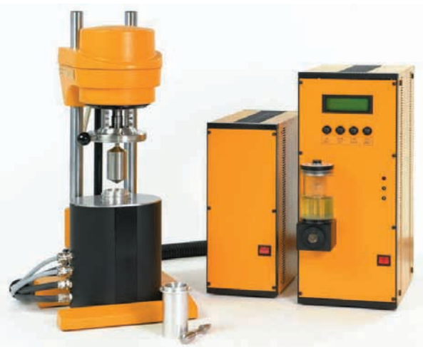
Реометр RN 5.3 в комплектации по ГОСТ 33137-2014 (RV)
