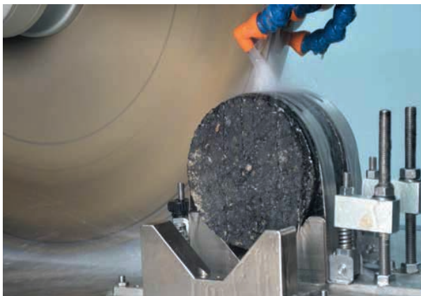
Резка керна (цилиндра) двумя дисками одновременно
