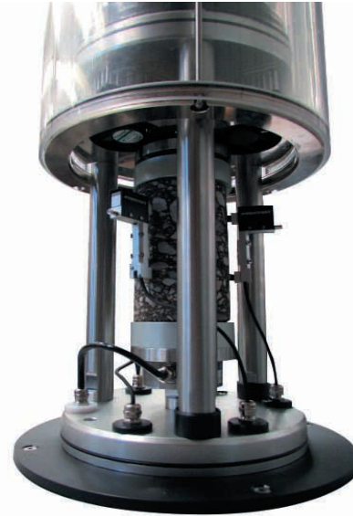
Образец с датчиками в нагружающей ячейке
